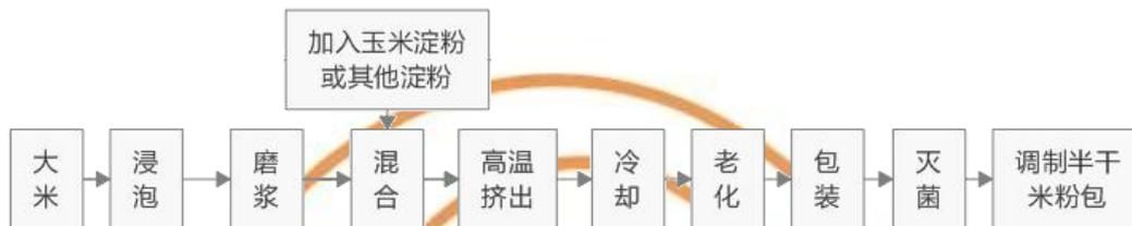
图2 调制半干米粉工艺流程
